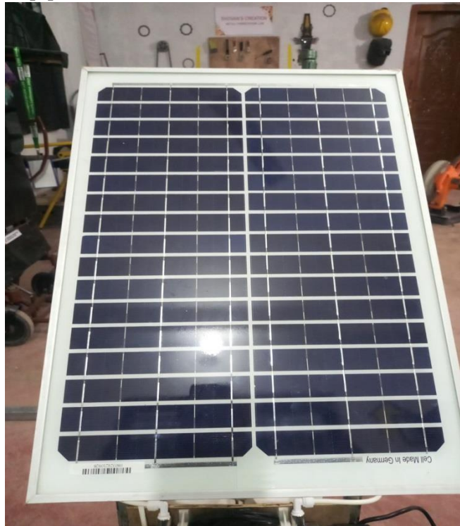
Fig 1.1.1: PV Solar Panel(20W)
