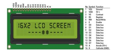
Fig. 3.4 16\*2 LCD Display
