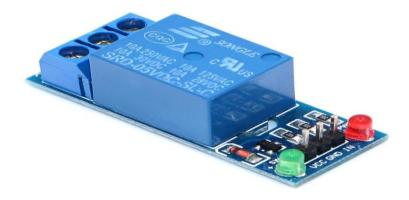
Fig 3.3: 5V Relay Module
