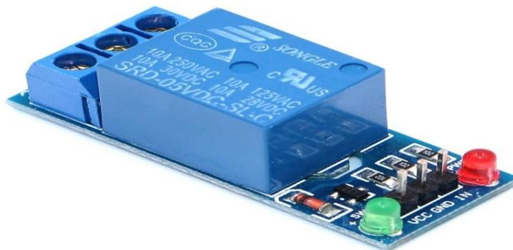
Fig 3.3: 5V Relay Module
