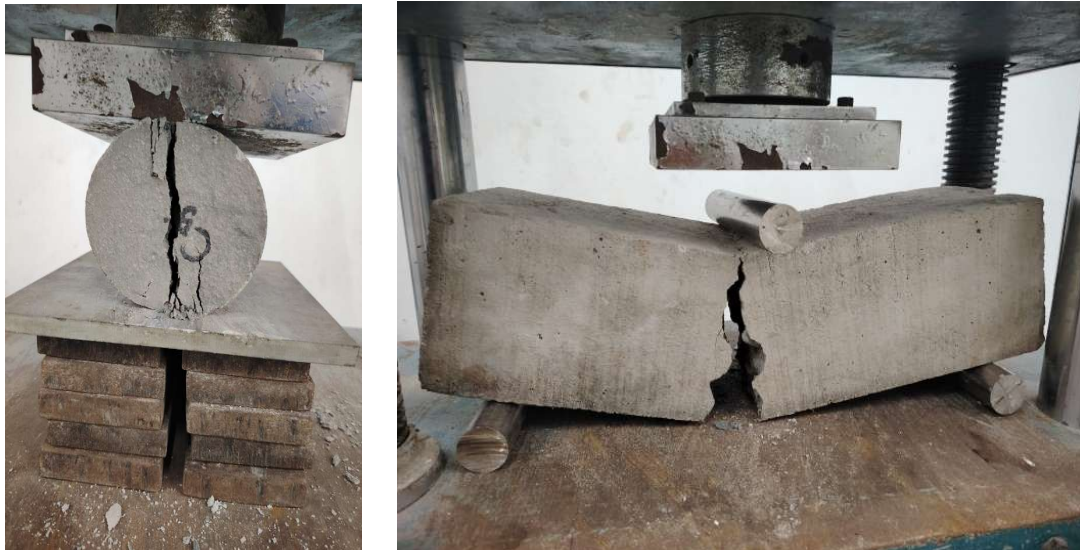
Figure 3.12 Spilt Tensile & Flexure test
