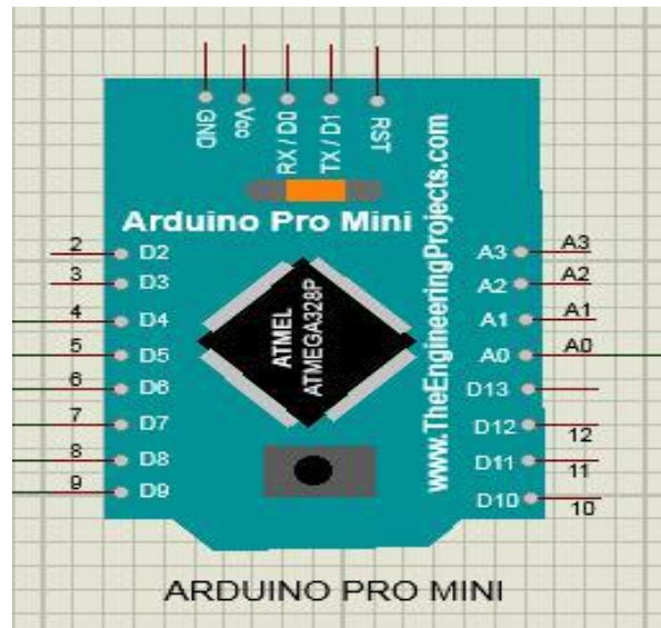
Figure 3.3 Arduino Pro mini Circuit Atmega328
