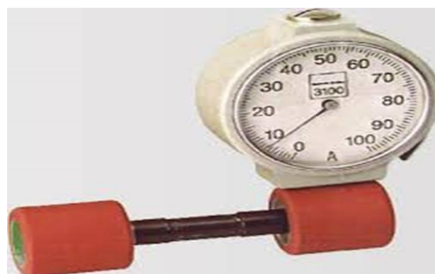
Fig: 3.6. Top Roller cots shore hardness
