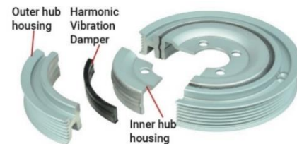
Fig: Vibration Damper
