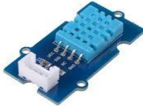
3.13Fig: Humidity Sensor
