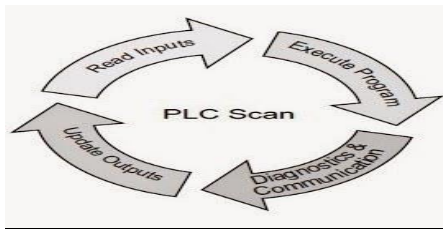
Fig: 4.19- PLC scan Cycle
