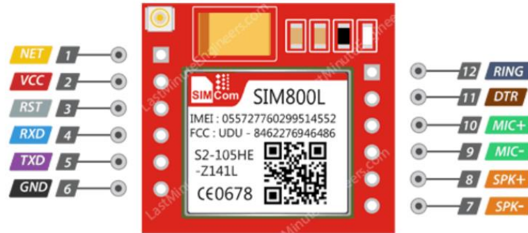
Fig 3.5 Pinout of SIM800L Mini GPRS GSM Module.
