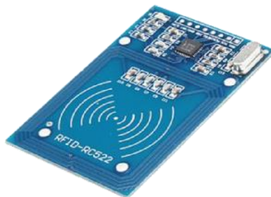
Fig: 3.6 RFID Card Reader
