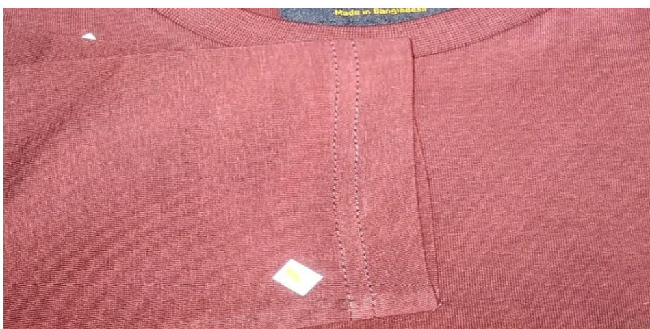
Fig: Tuck Missing
