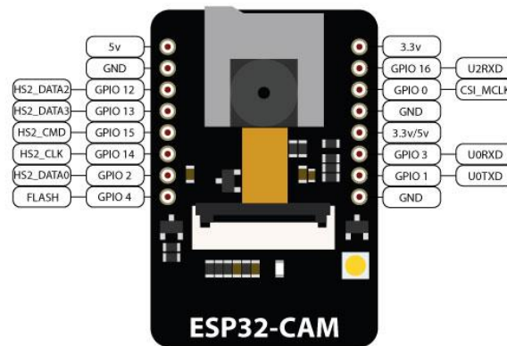
Fig-4: ESP-32 CAM Module.
