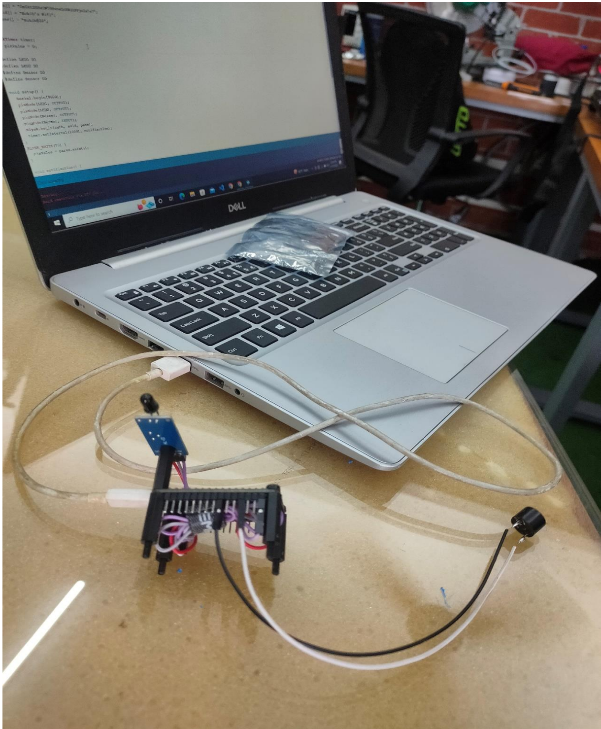
Fig. 3-10.Upload the code on nodemcu (ESP8266).
