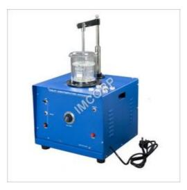
**Fig 5 : Disintegration Apparatus**
