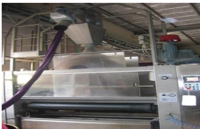
Fig: Dewatering Machine
