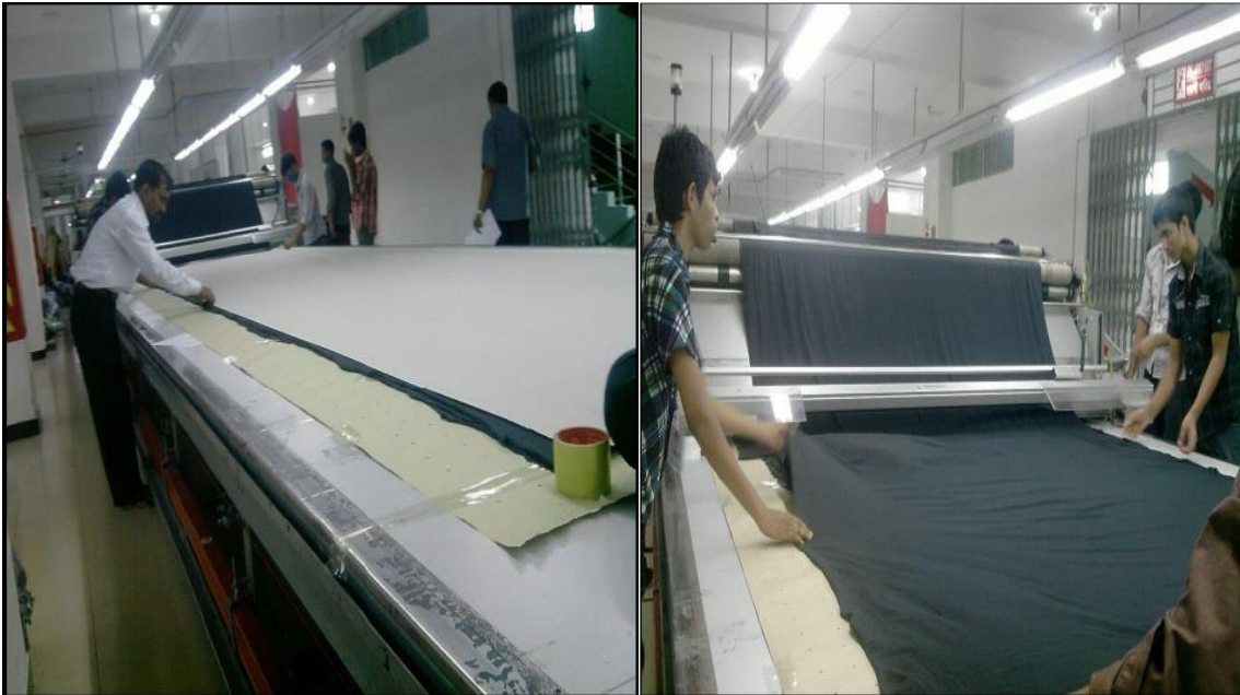
Fig: 3.20 Fabric spreading
