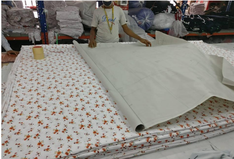
Fig: Fabric Spreading
